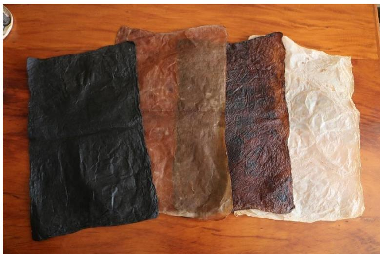
O TEXTICEL é um material têxtil sustentável composto por celulose e produzido a partir de fermentação bacteriana. Possui baixa pegada hídrica, é completamente biodegradável e utiliza resíduos industriais em sua produção. Além disso é vegano.
