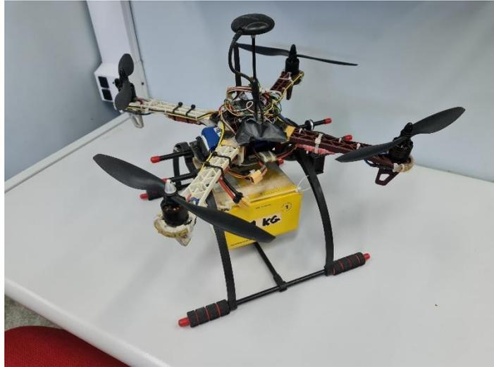
Veículo aéreo não tripulado acionado por 4 motores elétricos e sistema de controle integrado, capaz de ser programado para voo autônomo. O veículo foi inteiramente desenvolvido com base em informações disponíveis na internet, sendo fácil de replicar. Tem capacidade para levantar 500 g e é preconizado para o uso em sistemas de inspeção e monitoramento.
